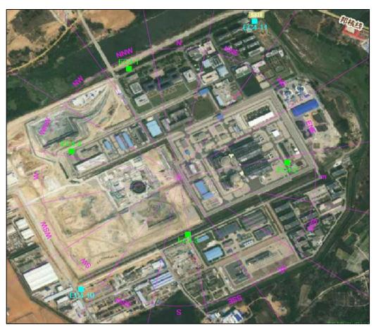
图 1: 厂内空气吸收剂量率连续监测点
